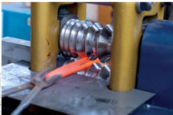
↑ Walcowanie na gorąco kęsa NiTi
